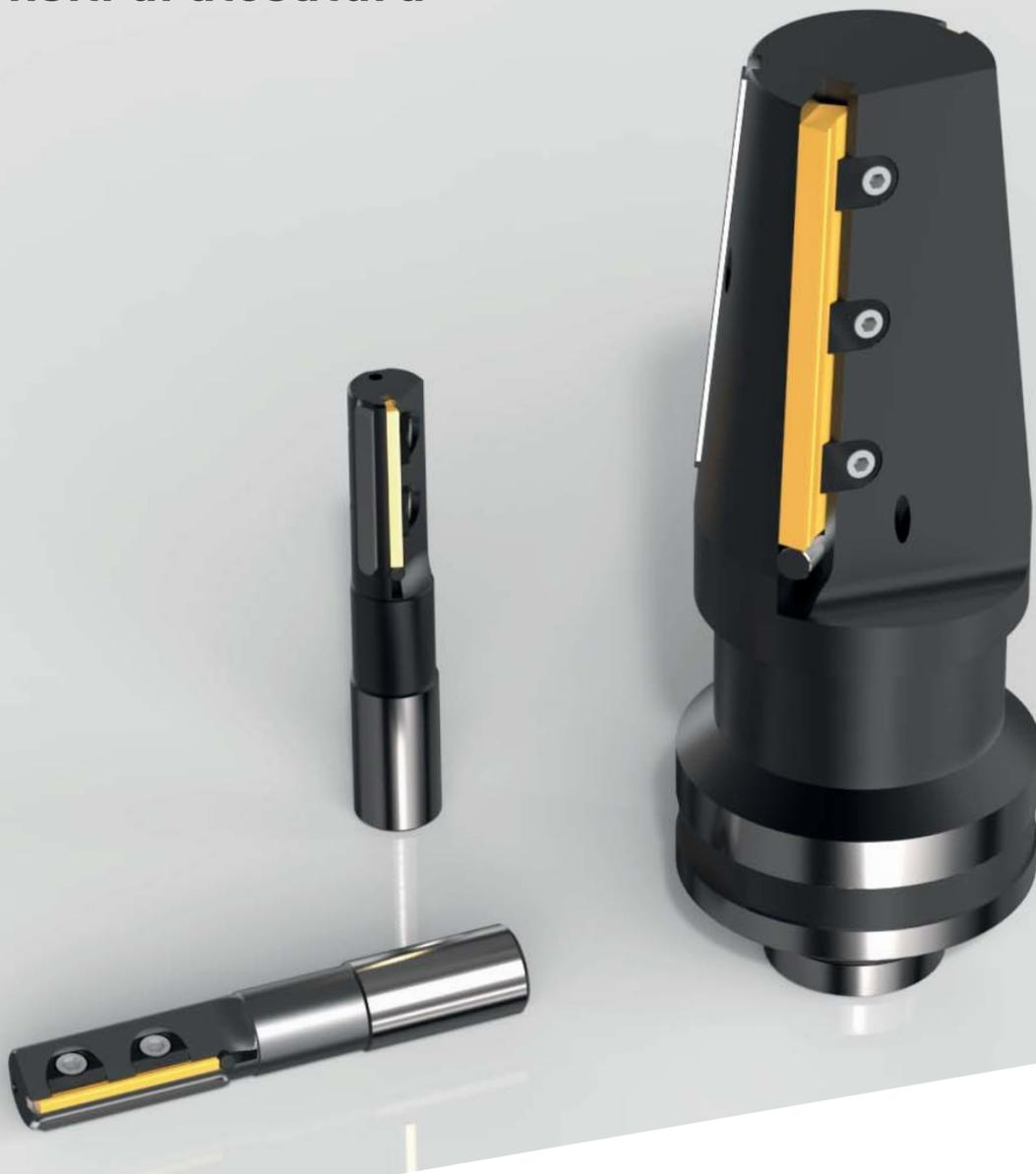
I BLADE FIX , alesatori a lama intercambiabile e registrabile micrometricamente, sono uno dei fiori all'occhiello del programma produttivo di CUS Utensili. Gli alesatori sono costituiti da una lama fissata meccanicamente sul corpo e da pattini guida. Vengono in questo modo garantite la stabilità nella lavorazione e un'ottima geometria del foro da alesare. La lieve pressione esercitata dai pattini sulla parte lavorata permette di migliorarne la superficie (finitura ottenibile Ra 0,20 - 0,80).
