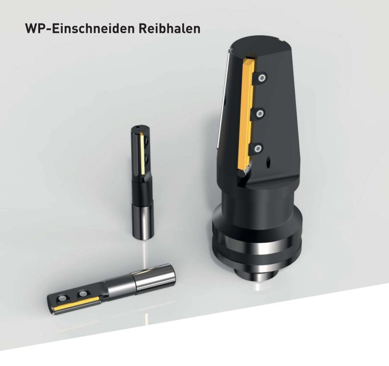
Blade Fix Einschneiden-Reibahlen mit Wendeplatten und Führungsleisten ermöglichen eine perfekte Bohrungsgeometrie und erreichen eine hervorragende Oberflächengüte. Das Zerspanen des Werkstoffes und das Führen der Reibahle in der Bohrung übernehmen Wendeplatten mit Präzisionsschliff und Führungsleisten an den geometrisch günstigsten Positionen.
